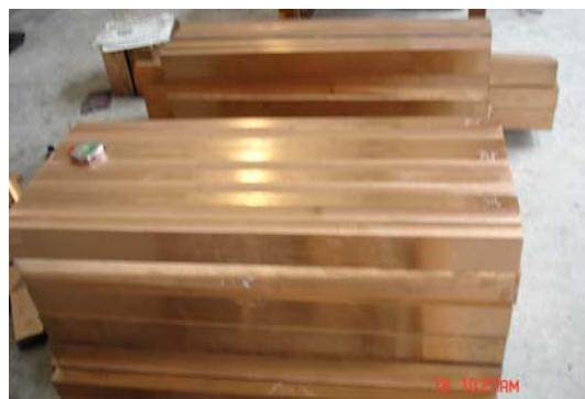
汽轮发电机转子槽楔铜合金
