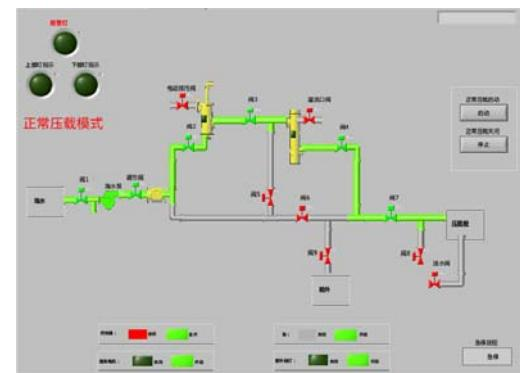
图 3. 压载水正常压载画面
