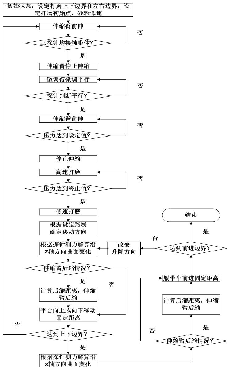
图1 船体打磨机器人打磨控制流程图
