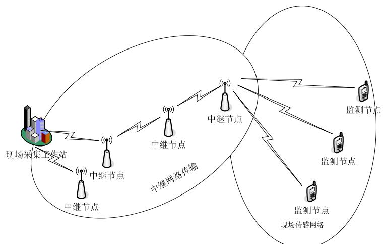
图 2 无线传感器网络结构示意图
