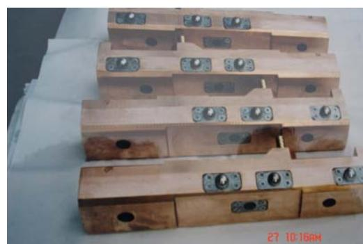
铁路钢轨对焊铜合金电极
