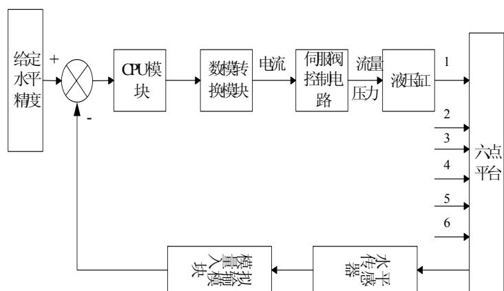
图 3 控制系统原理图
