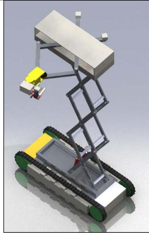
图 2 船体打磨机器人虚拟模型示意图
