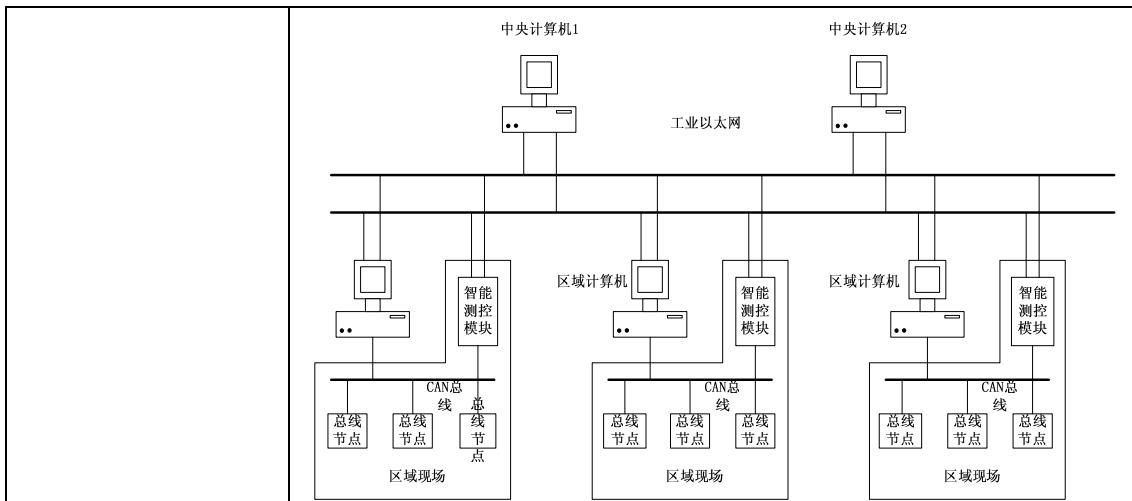
图 2 配电网监控系统示意图
