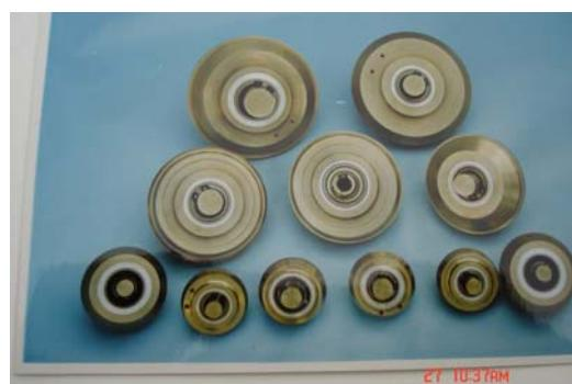
标准系列空罐电阻焊焊轮
