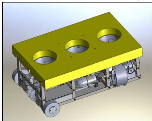
图 2 ROV 本体结构斜俯视图
